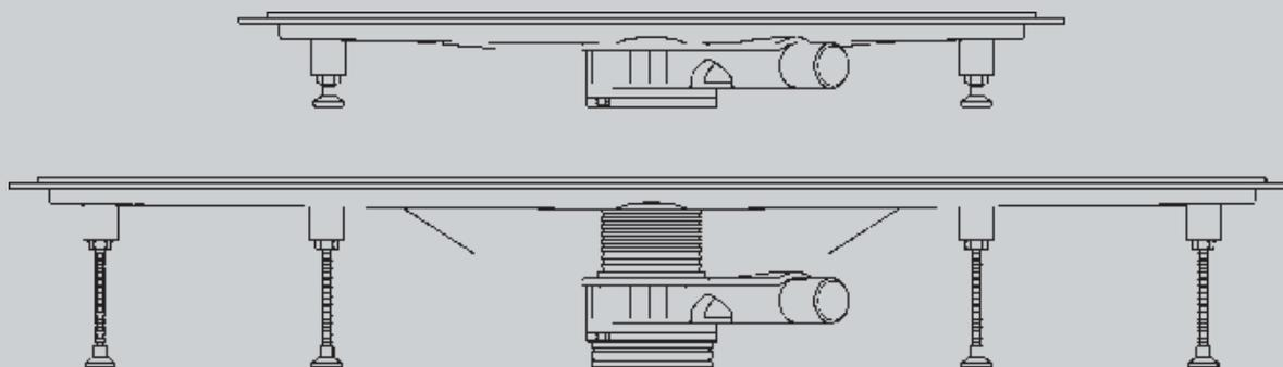
Благодаря низкой монтажной высоте (от 90 мм) душевые лотки Advantix идеально подходят для гибких решений при строительстве и ремонте.
